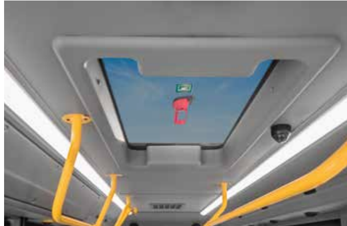
Trappe de toit électrique
