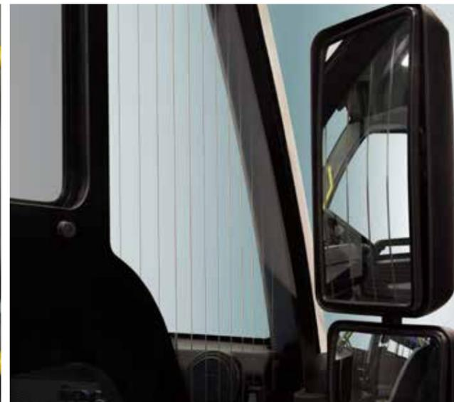
+ Rétroviseurs électriques d'accostage
