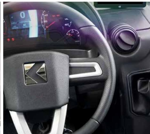
+ Volant électrohydraulique inclinable et télescopique
