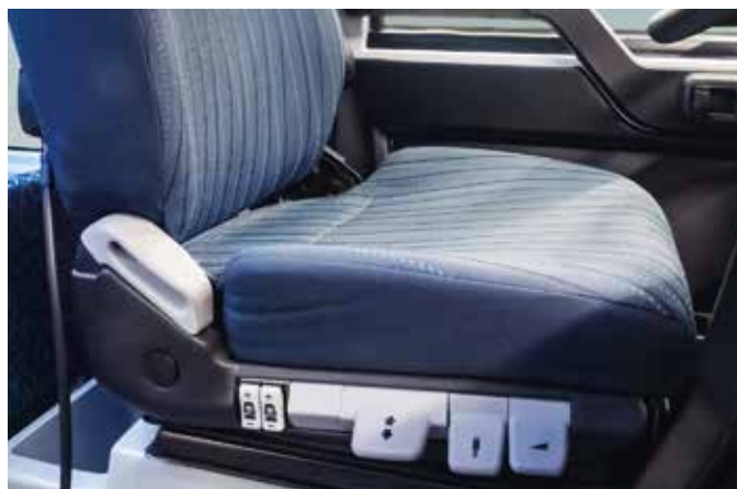
Siège pneumatique réglable 8 positions avec accoudoir
