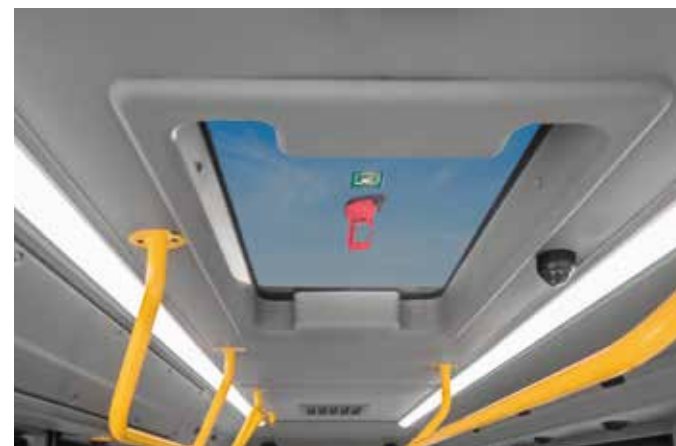
Trappe de toit électrique
